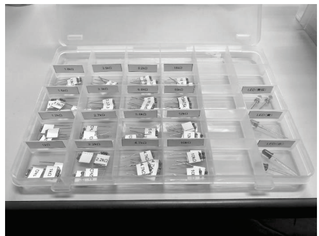
図9 グループ単位で利用する抵抗・LEDの部品箱
