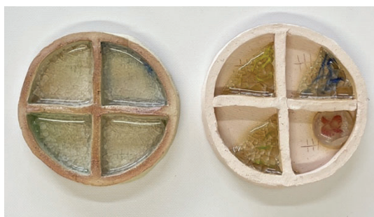
図 12_焼成温度の違いによるガラスの熔融実験 (2021年度, 多治見土, 左 1250°C, 右 1050°C)
