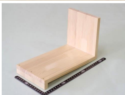
図2 植物油の拭き塗り仕上げ
