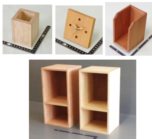
図1 ものづくり教室の製作題材から 上左から 文具立て(キヌカ), 木製クロック(蜜蝋), ブックスタンド(柿渋) 下左から 収納ラック(柿渋), 同(コーヒー溶液)
