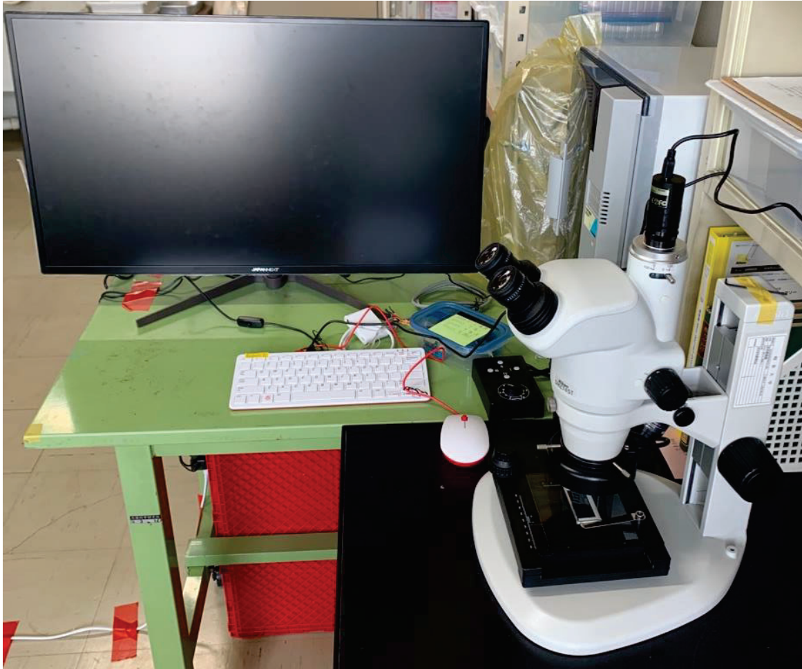
図2. 実体顕微鏡画像取得システム。左手前の顕微鏡直筒部には500万画素のUSBカメラ、対物レンズ付近に光源角度変化用のLEDリング照明が装着されている。顕微鏡奥の光源調節部とUSBカメラは、中央付近のキーボード型シングルボードコンピュータ（Raspberry Pi 400B）にて制御される。
