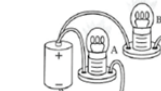
問6 下の図のように豆電球A,B,Cを電池につないで点灯させている。いま豆電球Cをソケットから外したとき、豆電球Aと豆電球Bの明るさは、最初のとどこと比べてどうなりますか。明るくなる・暗くなる・変わらない・消える、など、具体的に記述しなさい。その理由を書きなさい。
