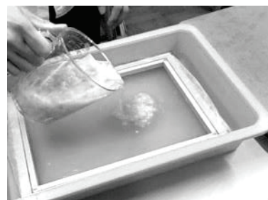
図4: 水に混ぜた楮を木枠に入れる
