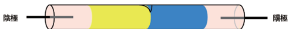
図2. 電圧を加えてしばらくたつと、寒天①が変色するようす。
