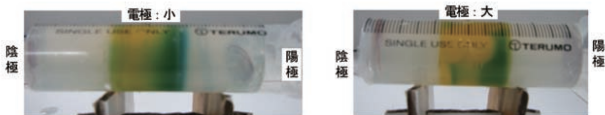
図8. 電極の大きさの相違の結果。左の電極は小さく（直径約1 cm）、右は大きい電極（直径約2 cm）を用いた。電気分解を開始してからの経過時間は、左が14分、右が8分である。
