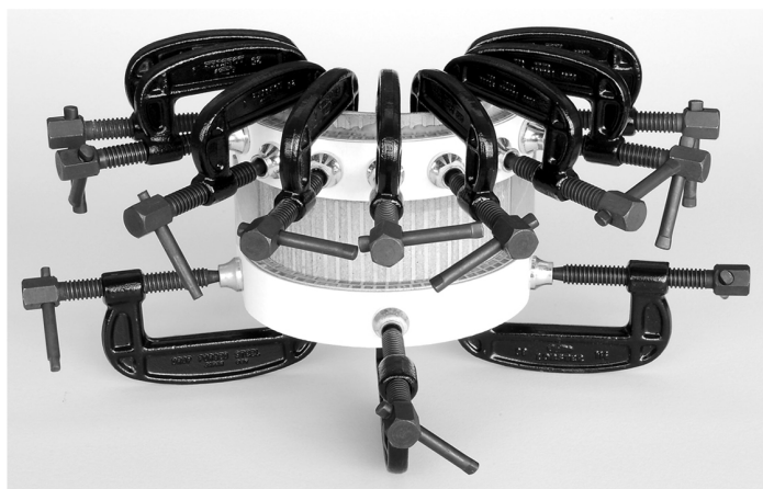
図10 2枚重ねた補強部品を木型に当ててTパークランプで成形
