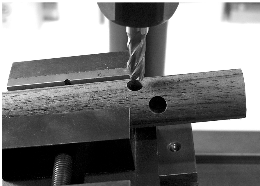
図3・4 (上) 真鍮棒を使った脚上下分割部分の連結 図5 (下) 脚へのバイパス・ソケットの加工
