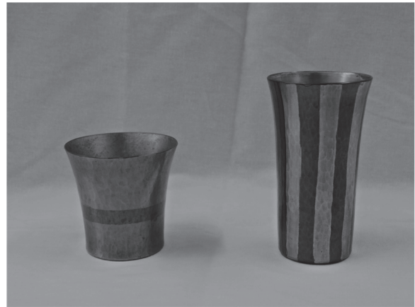
図 1 純銅製タンブラー 左：鋤起加工，右：へら絞り加工
