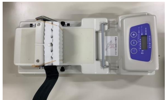
図 1 幼児の足のサイズに合うように補助材を取り付けた，足指筋力測定器 II（竹井機器）
