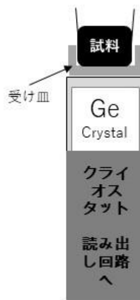
図1 ゲルマニウム検出器のセットアップの概略図
