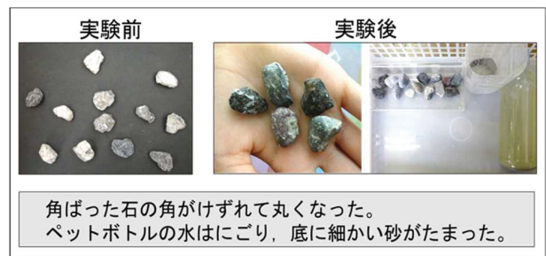
図5. 実験前の角礫と実験後の角礫と砂
