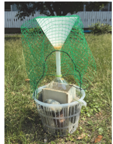
図 1：地面に固定された口径 18cm 漏斗付きペットボトル雨量計
