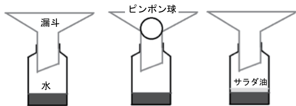
図3. 蒸発防止策の模式図(左図: 条件①防止装置なし, 中図: 条件②ピンポン球法, 右図: 条件③オイル法)
