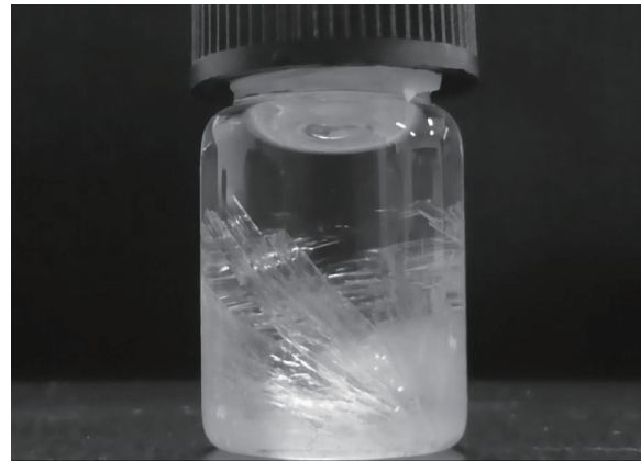
図7. 南極石の固化。24°C以下に温度を下げると、容器の下面から針状の結晶が成長し、容器の上部の空気の体積が増える。
