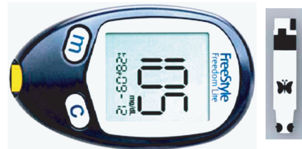
Fig.2 ニプロF (GDH電極法) (左: 本体, 右: センサー)
