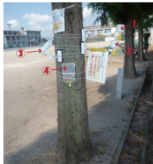
図2. 合渡小学校における観測機器の設置例（1温度計、2湿度計、3放射温度計、4観測防水ケース付データロガー）。
