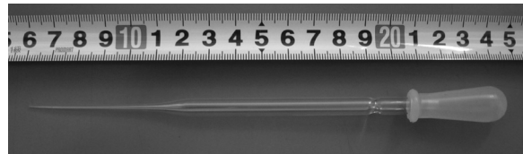
図2. 先端部が加工されたパスツールピペット．
