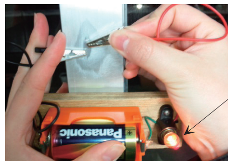
図5. アルミの窓枠の表面をヤスリで削ると、電気を通し電球が点灯する。
