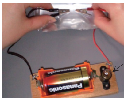
図6. 缶の内側は、電気を通さず、電球は点灯しない。
