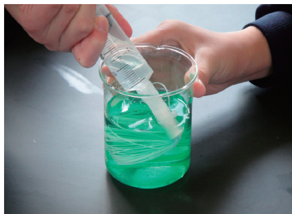
図1. 実験用中空糸膜。水性インクの粒子など0.01 \mu\text{m} 以上の粒子をろ過することができる。
