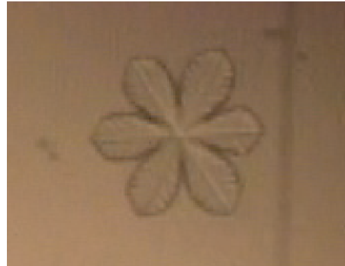
写真4. 完全分離型（樹枝状）結晶 表面温度 -14^{\circ}\text{C} 供給温度 -8^{\circ}\text{C}
