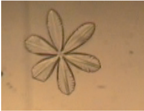
写真3. 完全分離型（樹枝状）結晶 表面温度 -12^{\circ}\text{C} 供給温度 0^{\circ}\text{C}
