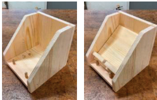
図6 底板にダボ(左)、受け板を取り付けた様子(右)
