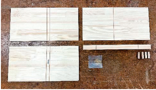
図2 開発したスマホスタンド題材の一人分の支給材料 t12×150×300の板材3枚、φ8mmの木ダボ4本、N25の真鍮 くぎ8本。製作時間短縮のため、一部に予め深さ1.5mmのガイド 溝加工を施してある(5.1節参照)。
