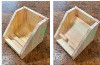
図5 底板に仕切り板(左)、受け板を取り付けた様子(右)
