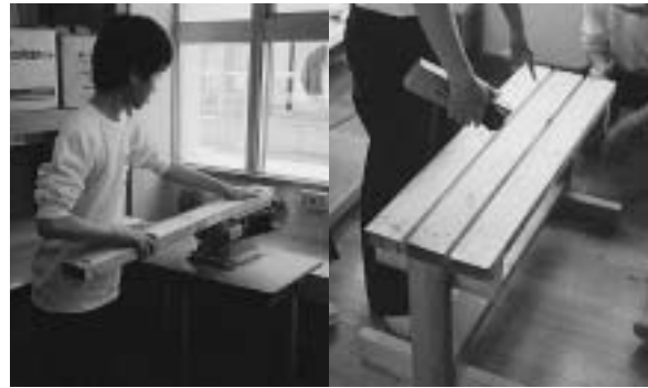
図6 解体材を使ったベンチづくり
