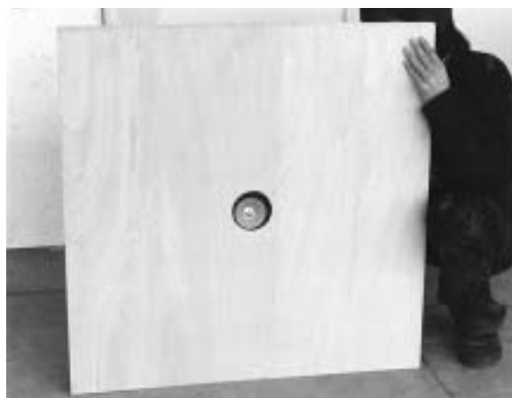
Fig. 4 平面バッフルの実験
