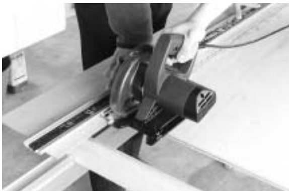
Fig. 7 捨て板式作業台の利用
