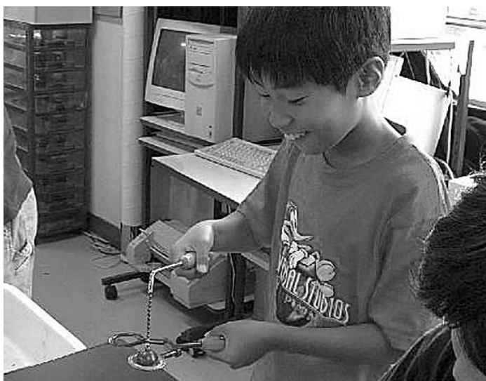
図1. 金属の膨張の学習で使用した教具。金属球を温めるとリングを通過しなくなる。
