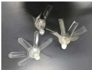
図11 ペットボトル製のプロペラ部
