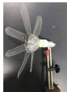
図14 モータ直結の風車
