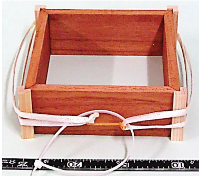
図9 木枠の接着・圧縮の工夫
