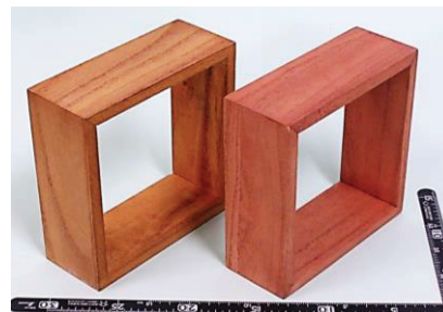
図4 コーヒー溶液（左）と無臭柿渋（右）で塗装した木枠
