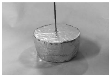
図5 発泡スチロールのディスプレーサ
