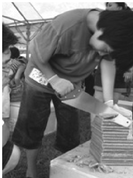
図6 片刃のこぎりで積層した段ボールを切る様子
