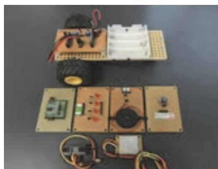
図8 各種センサとアクチュエータ
