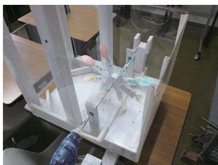
図7 ペルトン水車による発電装置 2), 3)
