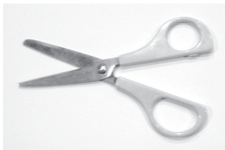
写真8 関のB社 幼児用はさみ 全長139mm、刃の長さ61mm、持ち手長さ78mm、重さ31g、開ける力の平均値143kg重
