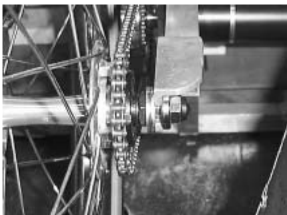
図13 ワッシャとチェーン中心調整
