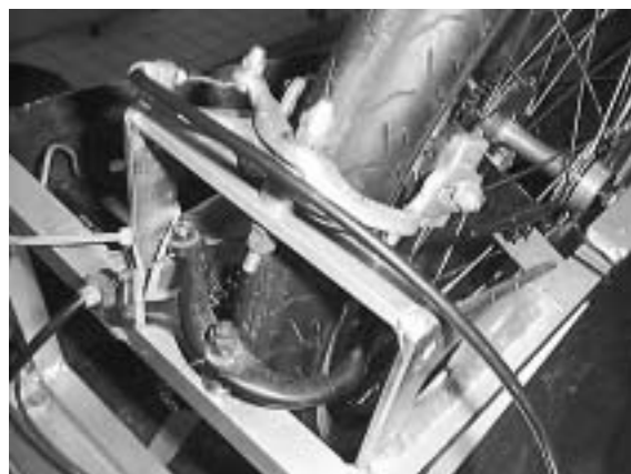
図14 2系統制動装置組みつけ
