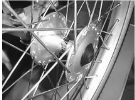
図10 車椅子用片持ちハブ(前輪使用)
