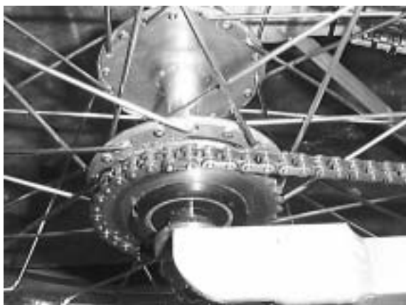
図12 後輪側スプロケット取り付け
