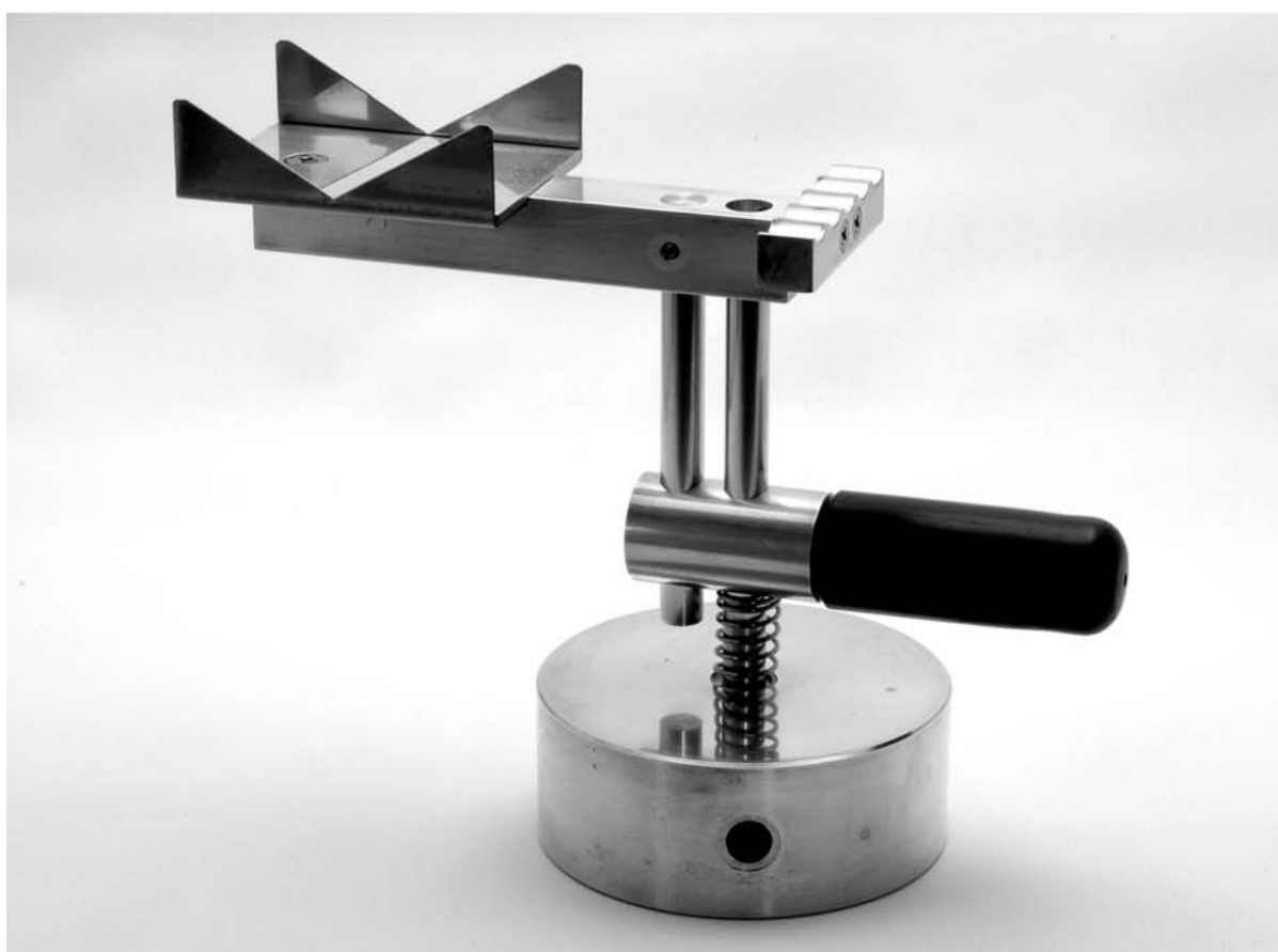
図1 (上) 予熱台A 真鍮, ステンレス 保持面の高さ90mm~115mm 重量約1585 g 2006年制作
