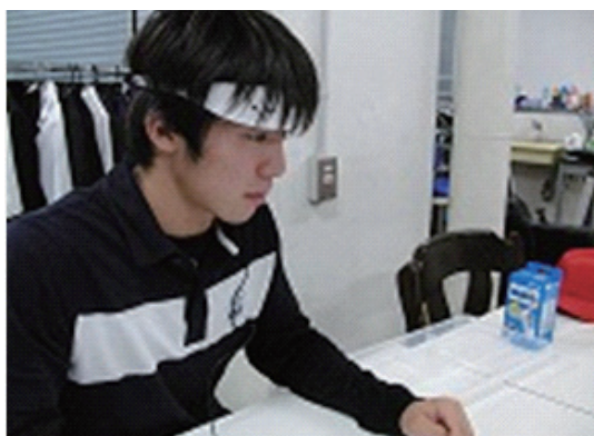
図1 頭部近赤外光計測装置装着の様子
